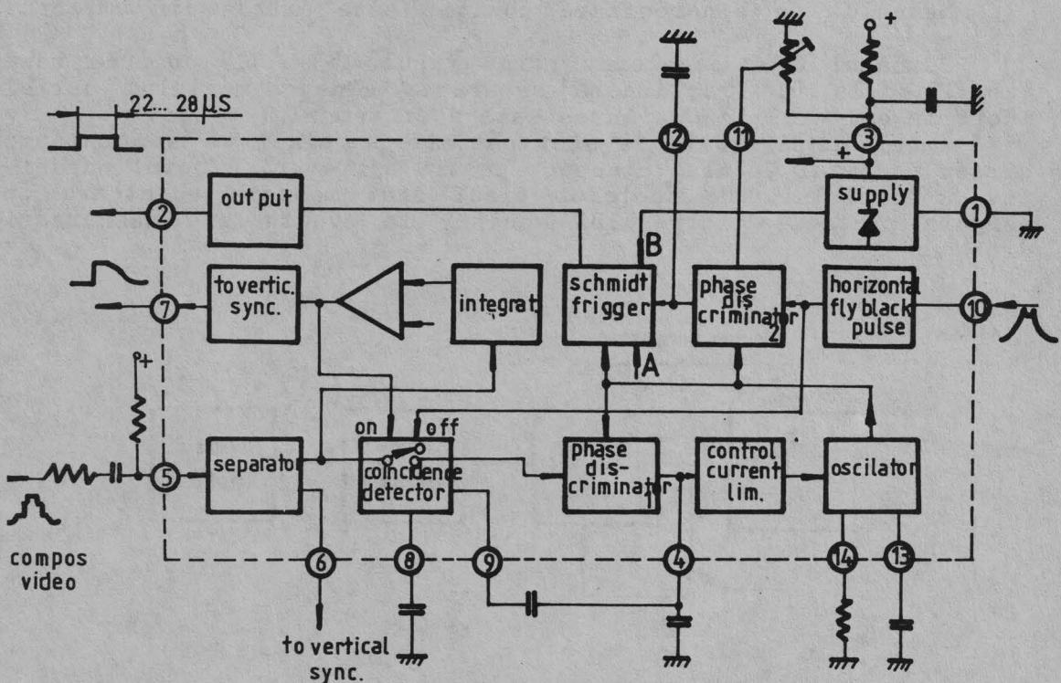
Cind lipsesc impulsurile de sincronizare a liniilor, oscillatorul intern are o frecventa libera de oscilatie a carei valoare este determinata de doua componente externe  $R7=10.5\text{ K}\Omega\text{m}$  1% si  $C6=10\text{ nF}$  2%, la  $15625\text{ Hz} \pm 10\%$ .
